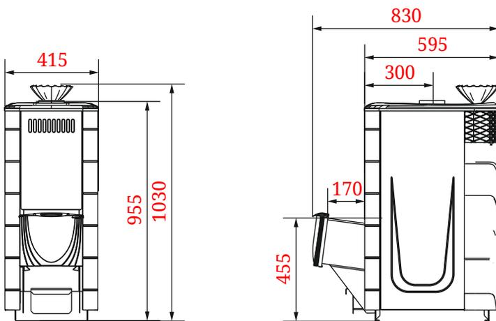
Рисунок 5. Габаритно-монтажные размеры печи «Гейзер XXL 2017 Inox»
