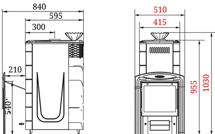
**Рисунок 6. Габаритно-монтажные размеры печи «Гейзер XXL 2017 Inox Витра»**
