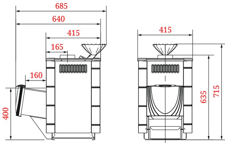
**Рисунок 7. Габаритно-монтажные размеры печи «Гейзер Микра 2017»**
