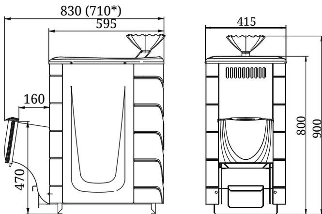
**Рисунок 3. Габаритно-монтажные размеры печи «Гейзер 2014»**
