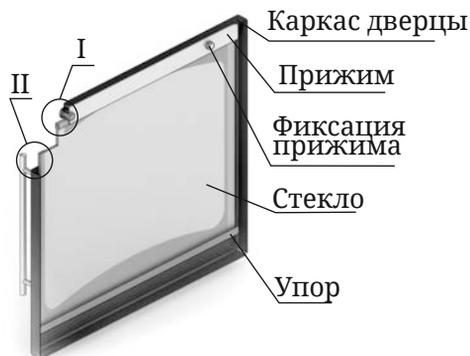
Рисунок 19. Ремонт светопрозрачного экрана дверцы модификации «Витра»
