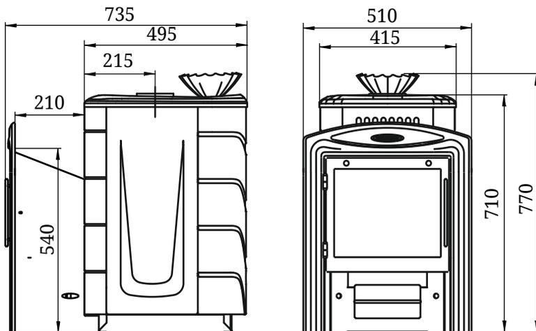
Рисунок 2. Габаритно-монтажные размеры печи «Гейзер Мини 2016 Витра»
