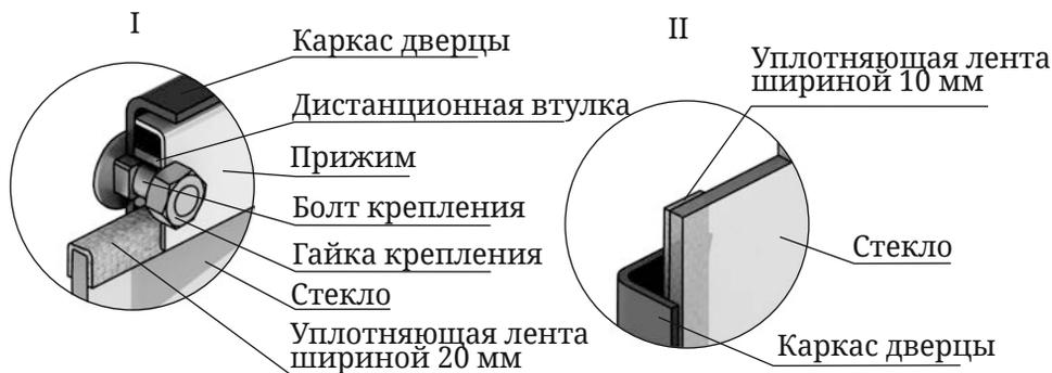
Рисунок 20. Крепление светопрозрачного экрана дверцы модификации «Витра»
