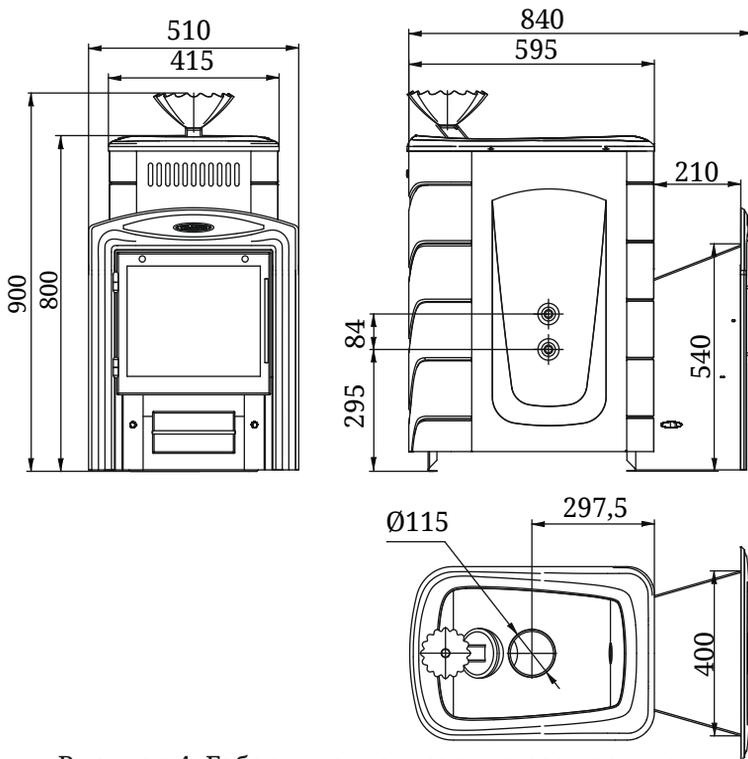
Рисунок 4. Габаритно-монтажные размеры печи «Гейзер 2014 Витра»
